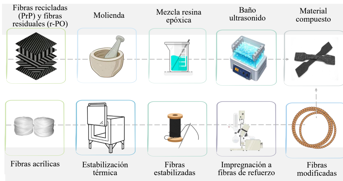
Figura 3.1. Proceso de preparación de materiales compuestos reforzados con fibras estabilizadas
