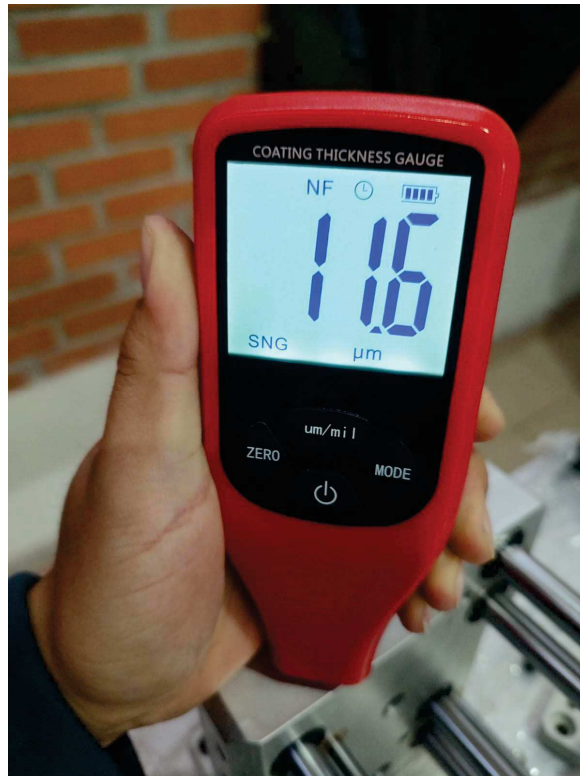
Ilustración 23 Anodizado de 23 minutos
