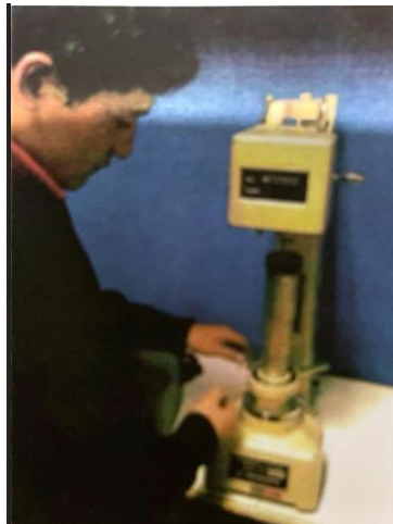
Figura 3.14 Prueba de dureza de Rockwell C para las herramientas
