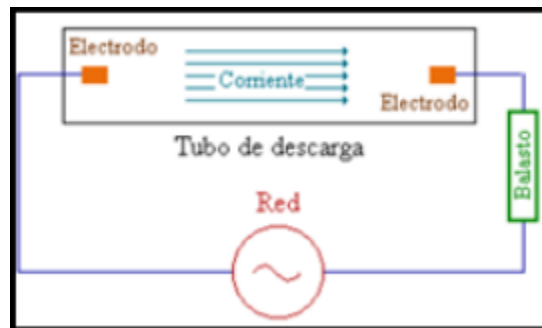
figura 17. circuito de una lámpara de descarga.
