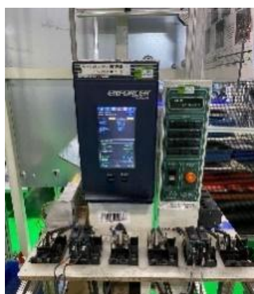
Figura 22 Torre de calibración de la línea de HOMB, fuente de Schneider Electric.
