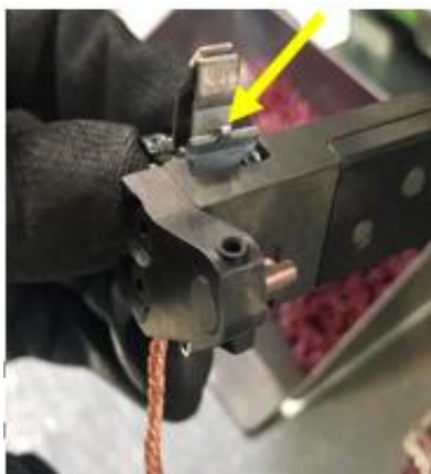
Ilustración 73 Se toma la armadura y se coloca a un costado del aditamento, fuente de Schneider Electric.
