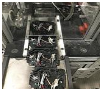
Ilustración 74 Se observan como se obtiene la misma posición de la trencilla para la siguiente estación, fuente de Schneider Electric.
