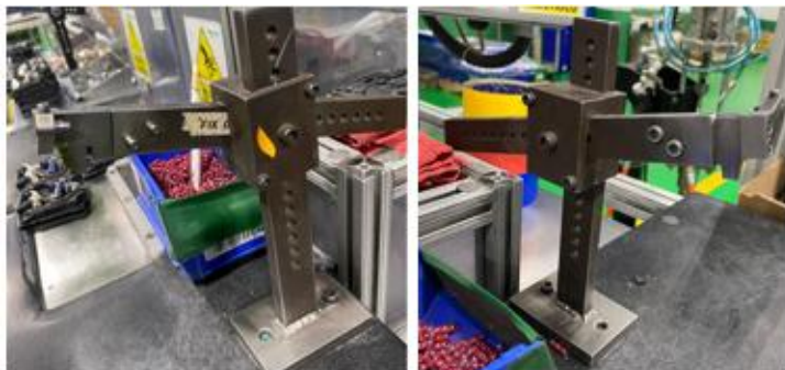
Ilustración 70 - 71 Aditamento puesto a prueba en la línea de producción, fuente de Schneider Electric.
