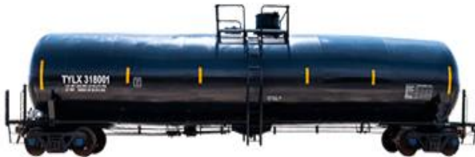
Ilustración 2. Vagón de ferrocarril tanque para transporte de líquidos.
