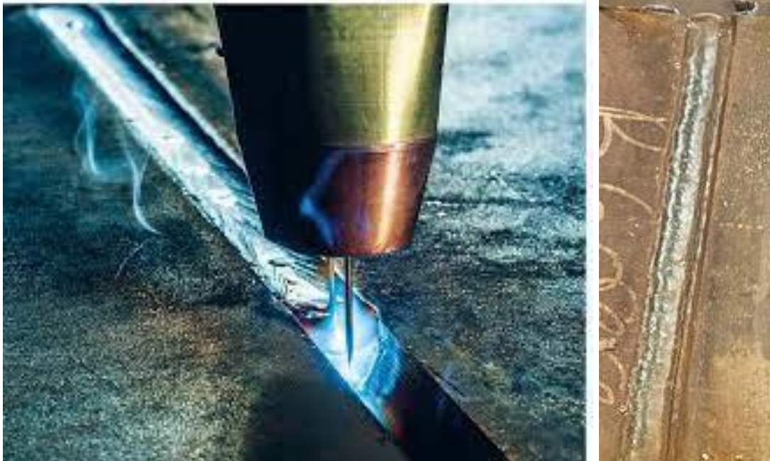
Ilustración 73 y 74. Soldadura de calidad en el ensamble del Draft Sill Web.
