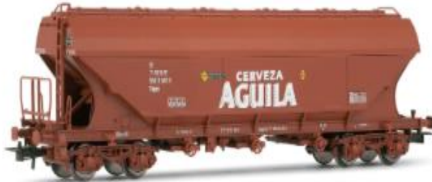
Ilustración 8. Vagon tolva cerrado para carga de cebada.
