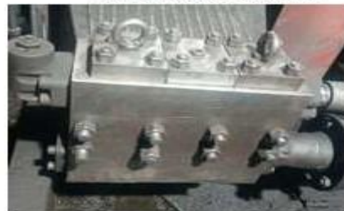
Cabezal reparado instalado
