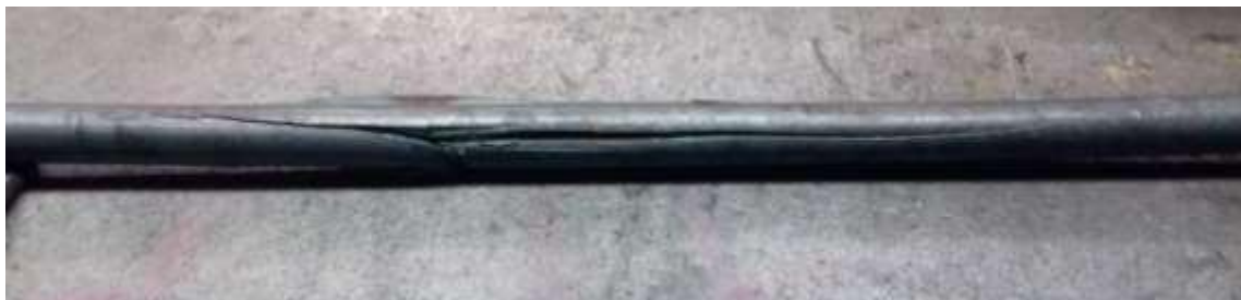
Ilustración 18: defecto superficial (empalme de palanquilla). (simec(2024)).
