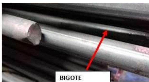
Ilustración 15: defecto dimensional (bigote). (simec (2024)).
