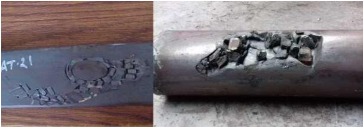
Ilustración 26: defecto superficial (material incrustado). (simec(2024)).
