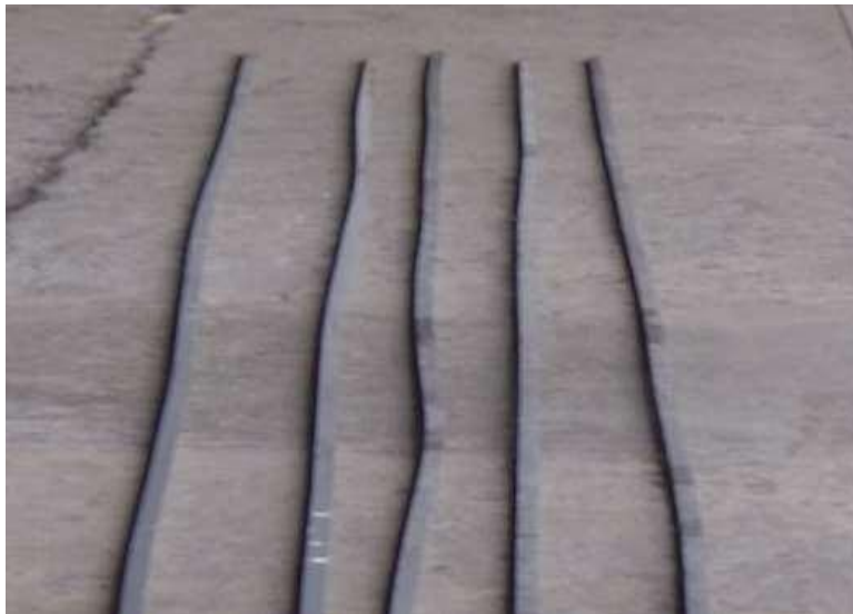
Ilustración 28: defecto superficial (rectitud fuera). (simec (2024)).
