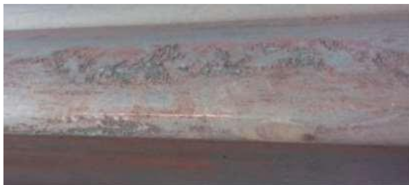
Ilustración 10: defecto superficial (incrustación de cascarilla). (simec (2024)).
