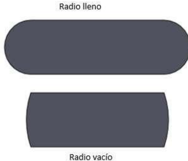
Ilustración 12: defecto superficial (radio vacío). (simec (2024)).
