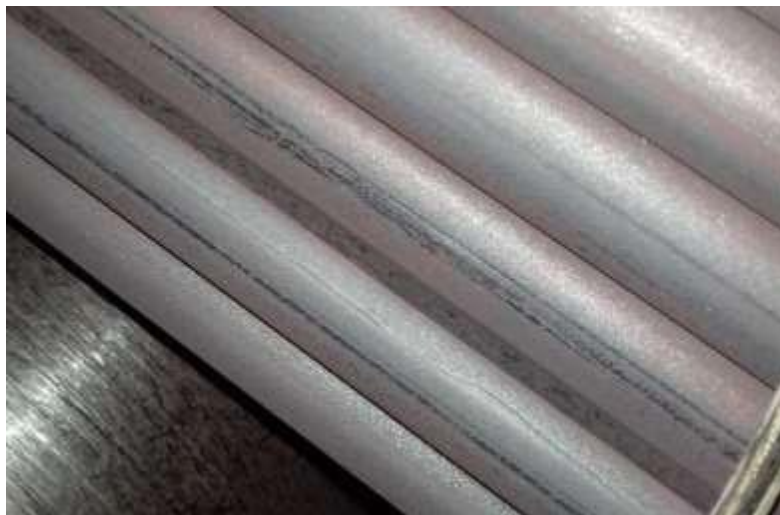
Ilustración 11: defecto superficial (marca de rodaja). (simec (2024)).
