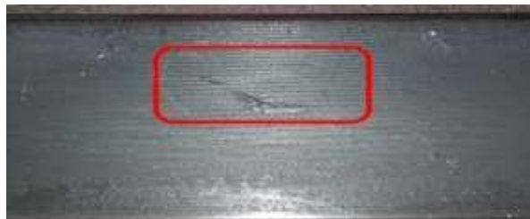
Ilustración 5: defecto superficial (Marca). (Simec(2024)).
