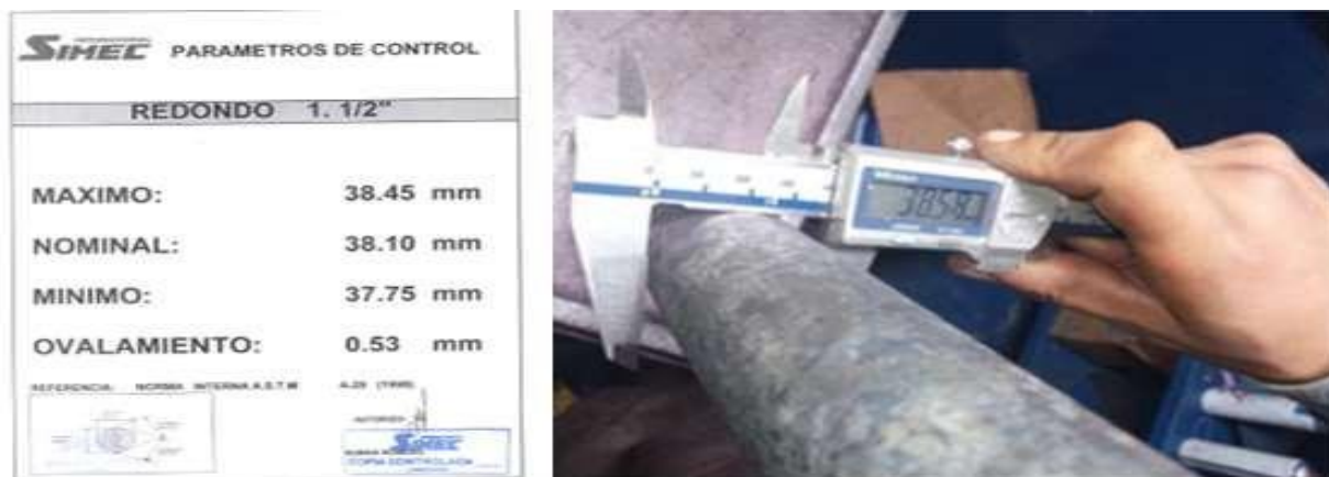
Ilustración 6: Defecto dimensional (Fuera de medida). (Simec (2024)).
