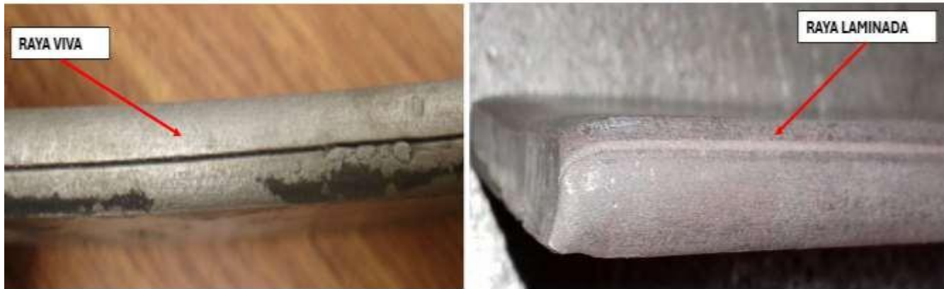
Ilustración 25: defecto superficial (raya viva o laminada ).(simec(2024)).
