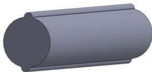
Ilustración 15: defecto dimensional (bigote). (simec (2024)).
