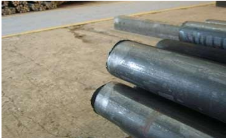
Ilustración 17: defecto superficial (corte con rebaba). (simec(2024)).
