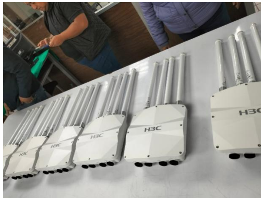
Figura 9.1 – Equipos H3C WA6620X destinados a la red inalámbrica del ITA
