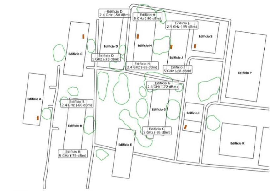
Figura 8.1 Mapa de cobertura estimada y ubicación propuesta de puntos de acceso inalámbrico.
