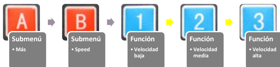
Figura 4.13 Pasos realizados en el panel de control para pruebas de velocidad del motor
