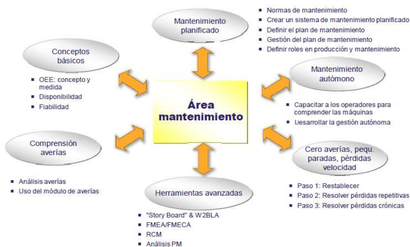
Figura 7 Componentes del área de Mantenimiento
