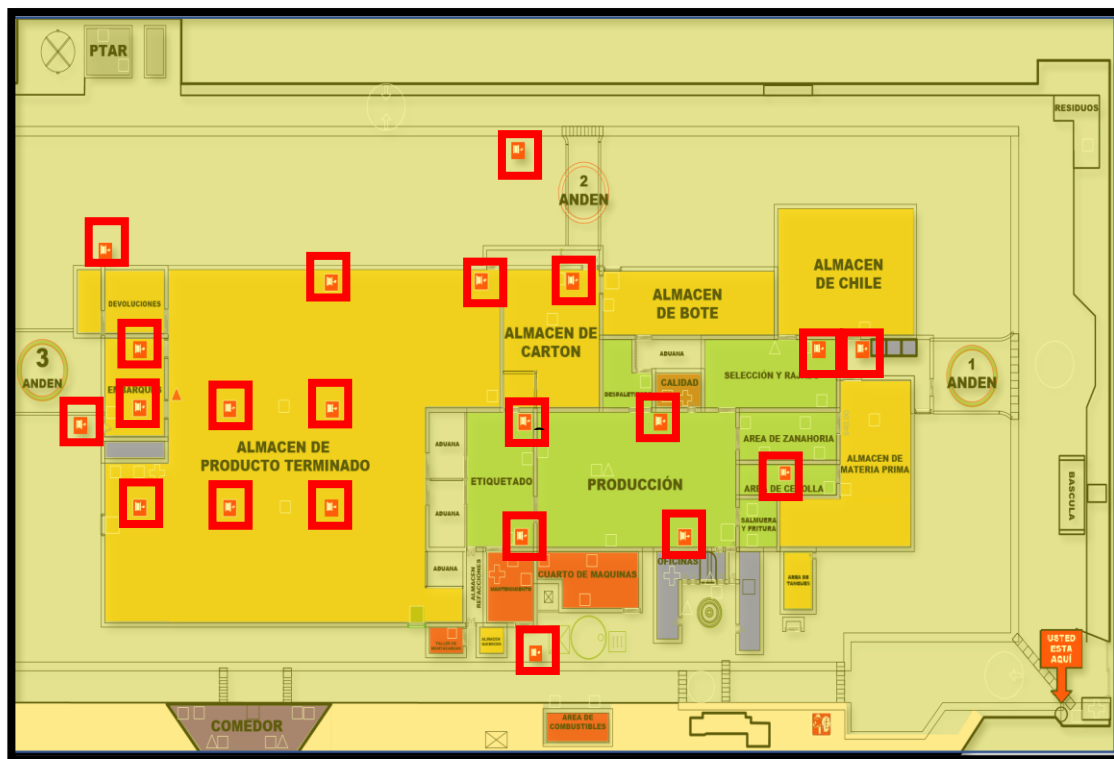
Ilustración 12. Lay out de identificación de hidrantes.
