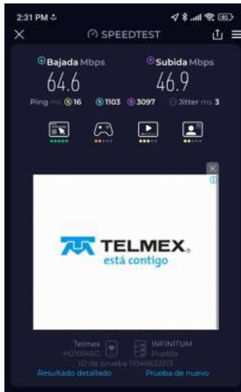
Figura 57: Test de velocidad en teléfono móvil desde el Auditorio municipal donde la velocidad alcanzo velocidades de 65 Mbps esto gracias al AP de uso industrial instalado.
