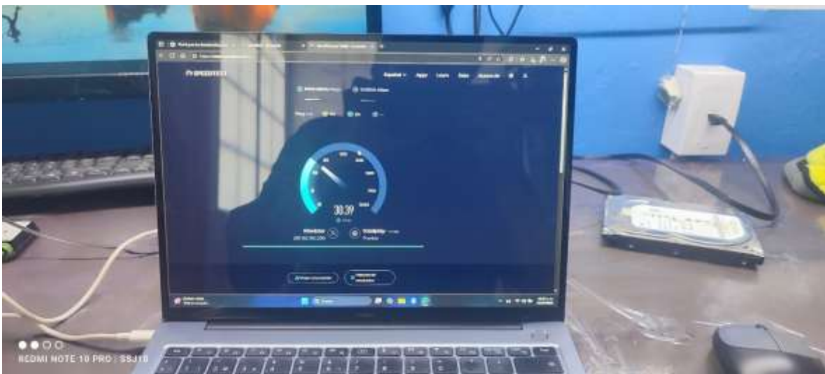
Figura 55: mejora de la velocidad en la planta alta llegando a los 30.39 Mbps.
