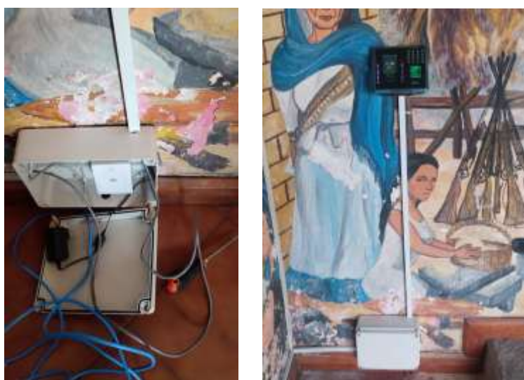
Figura 32: Instalación física de checador biometrico zteko.
