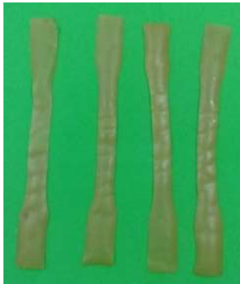
Figura 2.5 Probetas de biopolímero para las pruebas mecánicas.
