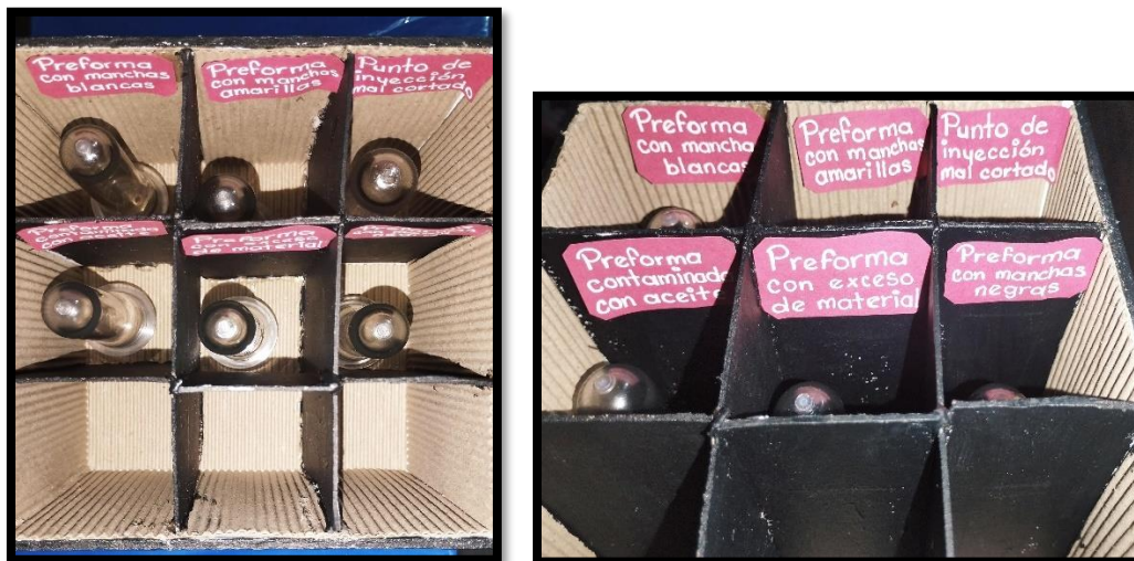
Ilustración 16. Caja de almacenamiento para muestras de piezas defectuosas
