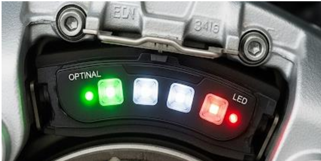
Figura 5. Interfaces de leds en balata de automóvil
