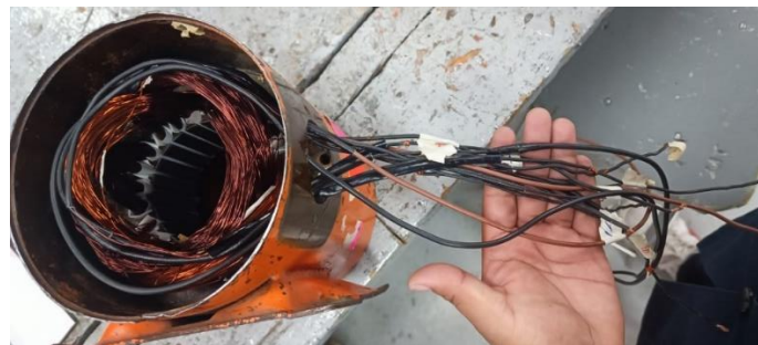
Ilustración 53 colocación de las puntas.
