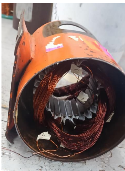
Ilustración 50 Colocación de bobinas.
