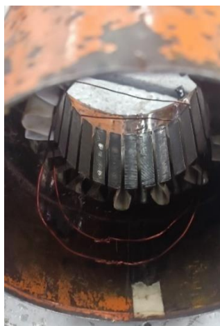
Ilustración 43 Medida de paso de bobina.
