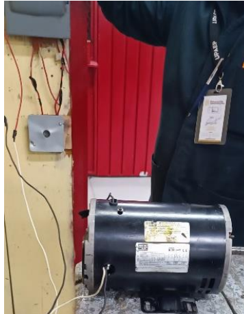
Ilustración 35 Funcionamiento del motor sin capacitor.
