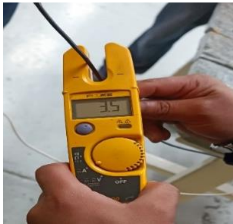
Ilustración 58 Medición de arranque.
