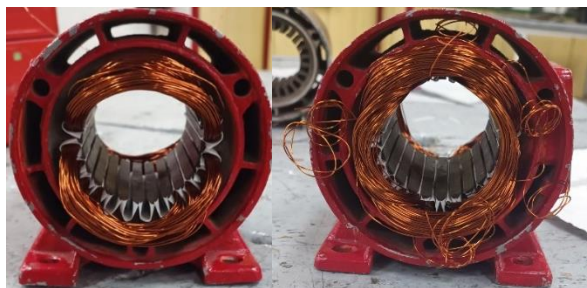
Ilustración 26 Montaje de devanado de Trabajo y Arranque.
