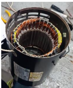
Ilustración 33 Revisión visual del estado del motor.
