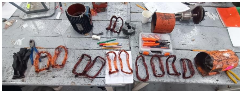
Ilustración 40 Desmontaje de las partes del motor.
