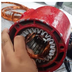
Ilustración 25 colocación de los devanados.
