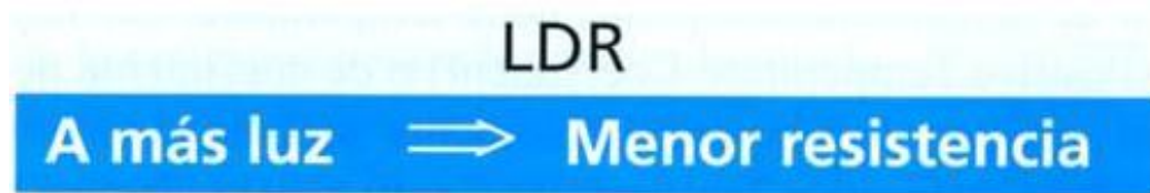
Figura 30 Qué es y cómo funciona una LDR (Creaciones Copyright SL. 2010. Consultado el 19 de febrero de 2018.)
