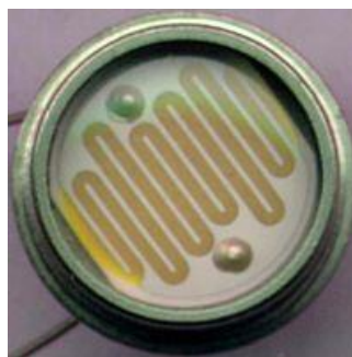
Figura 33 Cuerpo del LDR o fotorresistencia (Creaciones Copyright SL. 2010.)
