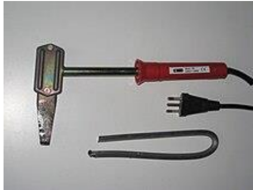
Figura 14 Soldador eléctrico. (En 1894, la American Electrical Heater Company empezó a fabricar soldadores eléctricos a gran escala en Detroit)
