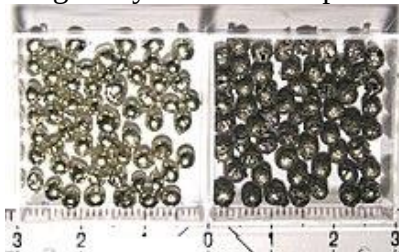
Figura 12 Estaño: \beta (izquierda) y \alpha (derecha). (Se cree que se descubrió en el mismo período que el cobre hace 6,000 o 6,500 años en los países del Mediterráneo, en Persia y la India.)
