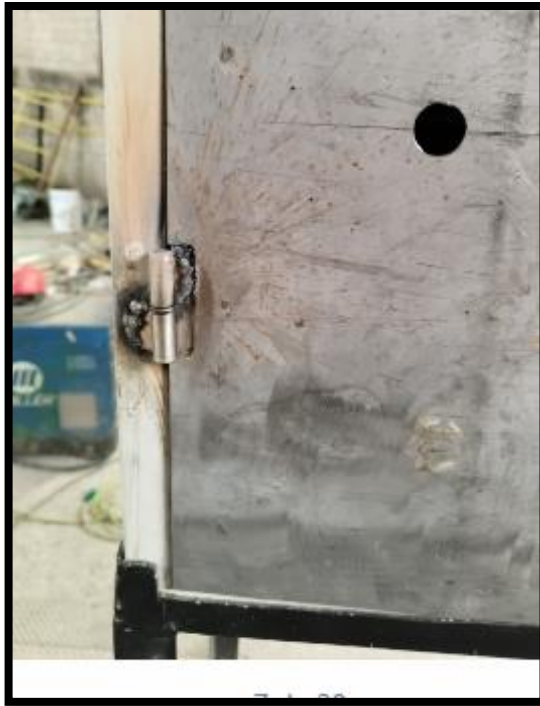
Imagen 87 Colocación de bisagras
