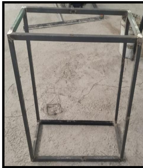
Imagen 113 Construcción del marco de gabinete
