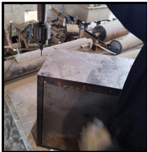
Imagen 114 Perforación para el remachado de laminas
