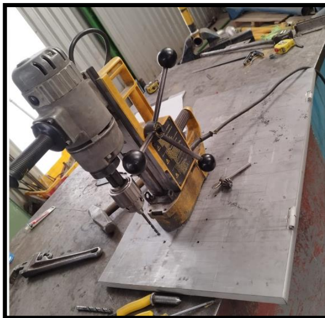
Imagen 83 Perforación de puertas para componentes indicadores
