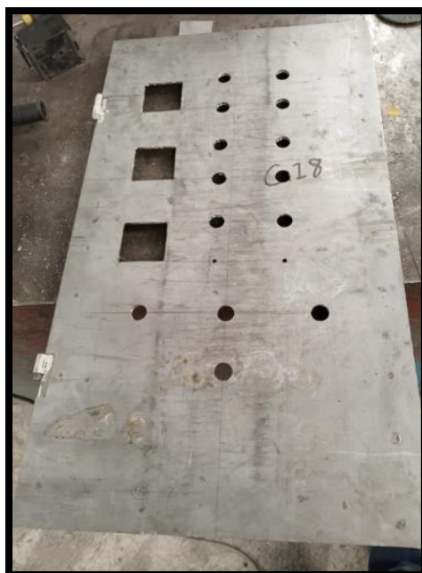
Imagen 84 Perforaciones de puertas del tablero del canal de fundición
