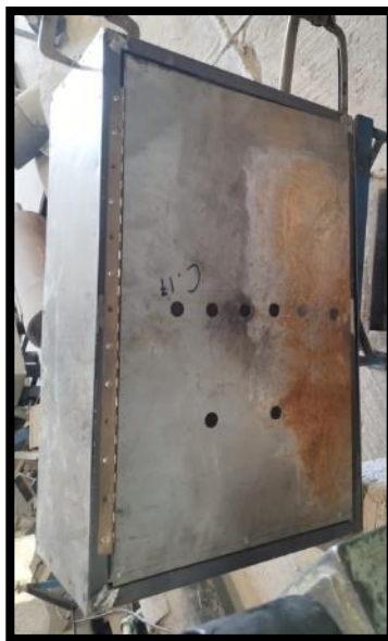
Imagen 115 Colocación de puerta al gabinete
