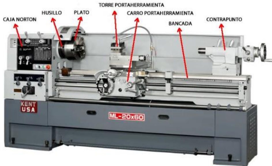
Figura 20. Partes principales de un torno convencional.
