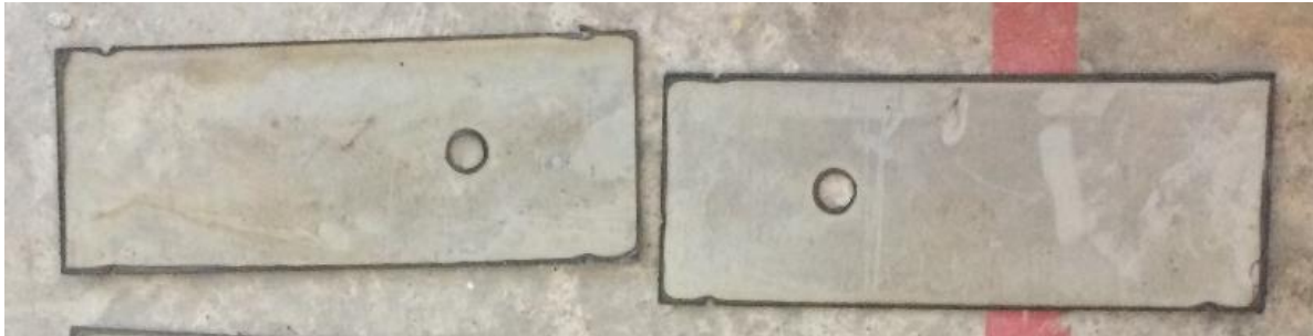
Figura 55. Laterales del gabinete de control con entrada o salida de cableado.
