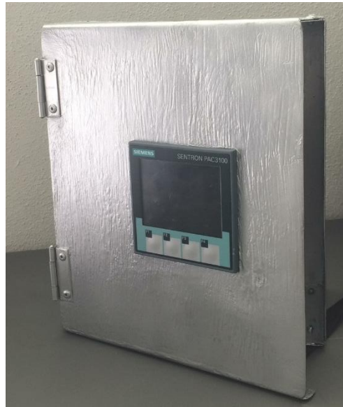
Figura 59. Resultado final del gabinete eléctrico con Sentron PAC 3100.
