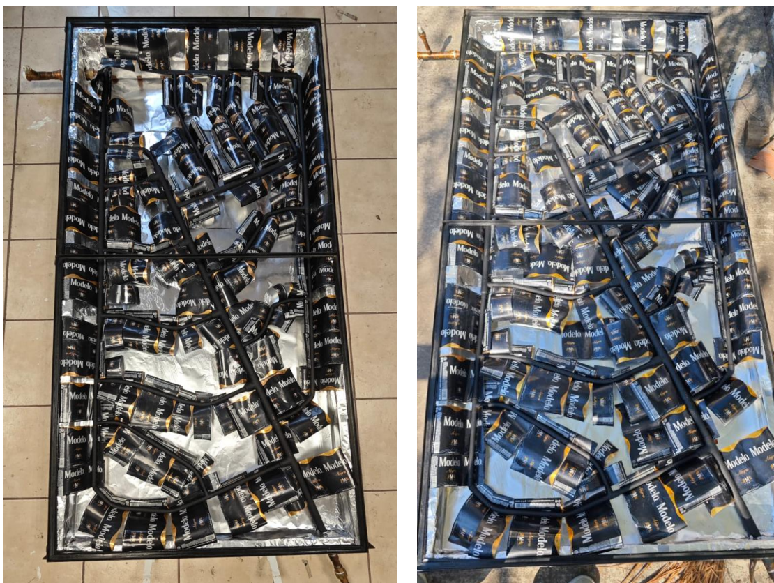
Figura 4.5. Instalación de aletas de aluminio reciclado sobre el arreglo de tuberías del colector para maximizar el área de captación e intercambio térmico.
