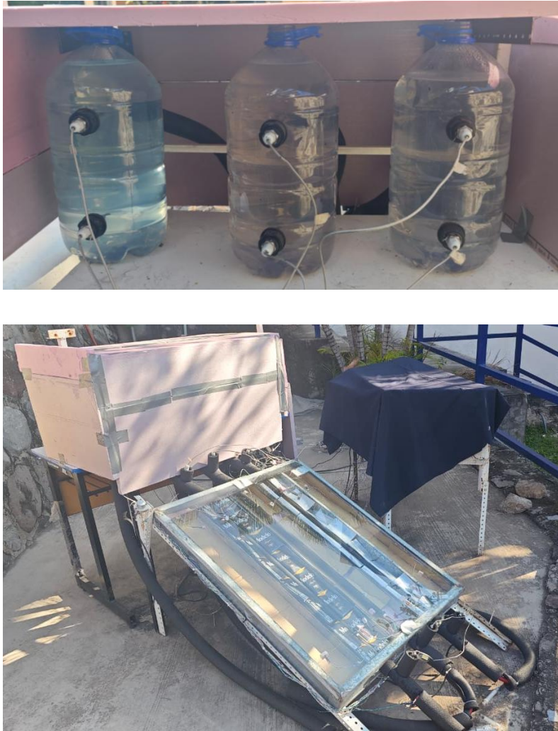
Figura 3.19. Montaje del prototipo para la evaluación de aletas de manera experimental.
