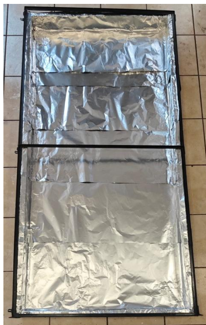
Figura 4.3. Protección del aislamiento térmico mediante hojas de aluminio en el interior de la carcasa para reducir degradación por exposición a radiación solar.
