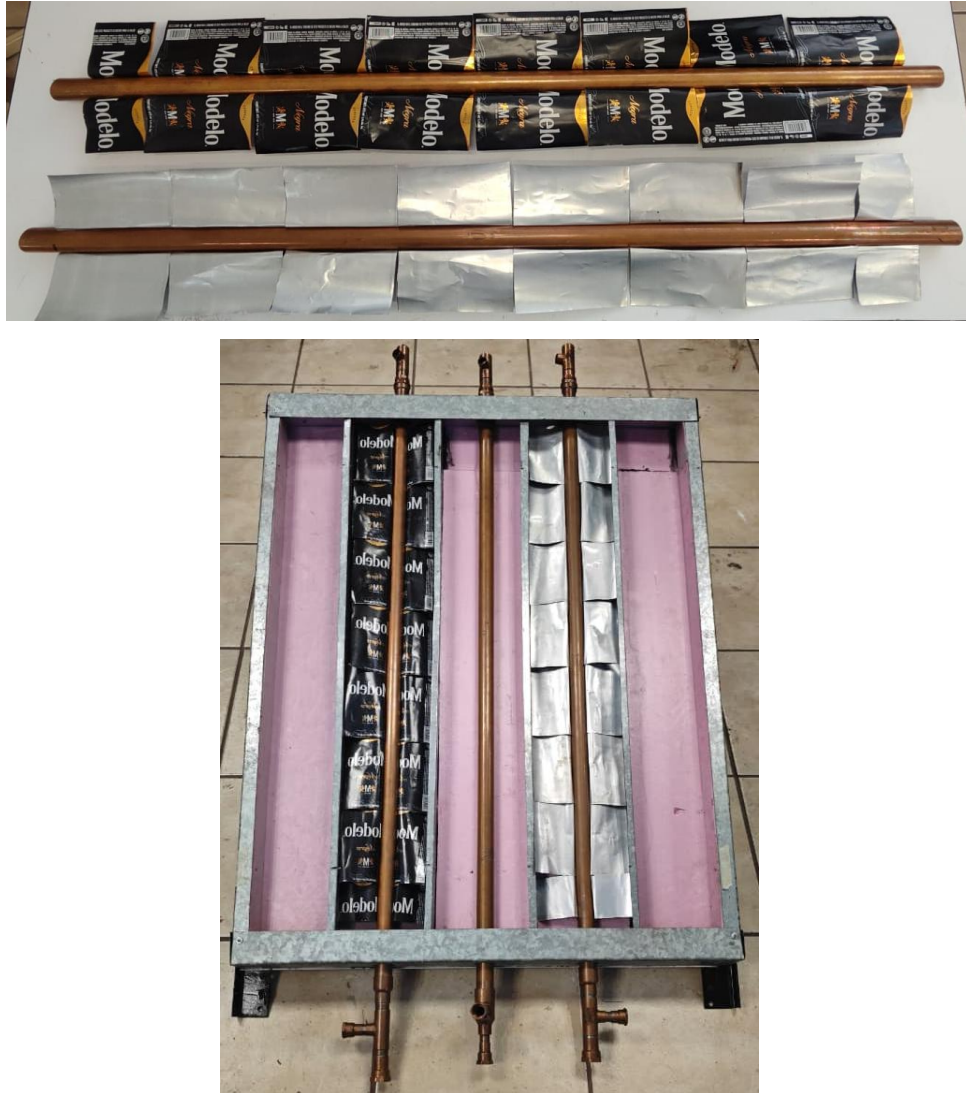
Figura 3.16. Instalación de las aletas y los tubos del prototipo.
