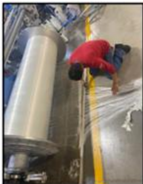
Corta el excedente de hilo antes de la prensa
