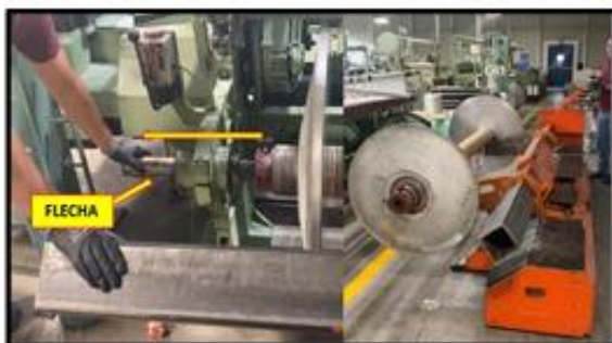
Con ayuda de la porta Beem carga un poco la brida de forma que facilite la salida de la flecha
