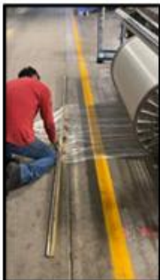
Corta el excedente de hilo antes de la prensa
