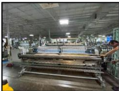
Alinea el bastidor a la altura del telar
