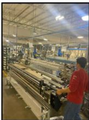
Alinea el bastidor a la altura del telar
