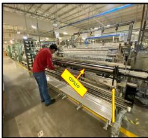
Las perillas que se encuentran en las orillas alinean el cepillo del bastidor. Gira ambas perillas (3 vueltas)
