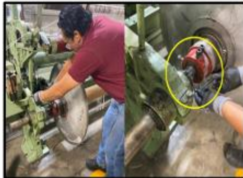
De acuerdo con el tornillo que se encuentre en la flecha toma una herramienta para aflojar los tornillos y es más fácil su salida de la flecha
