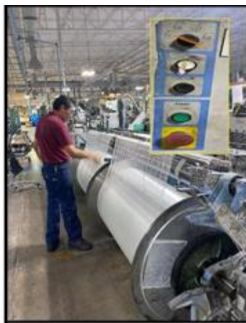
En rolla los hilos en la misma y colócala sobre el telar
