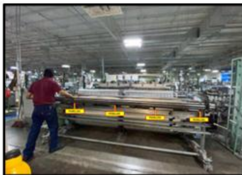
El bastidor tiene 5 perillas de alineación, se encuentran debajo del cepillo del bastidor. Deberá girar las perillas a la izquierda para cerrarlas completamente
