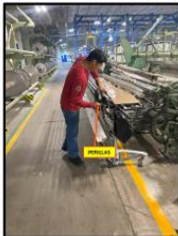
Las perillas que se encuentran en las orillas alinean el cepillo del bastidor. Gira ambas perillas (3 vueltas)
