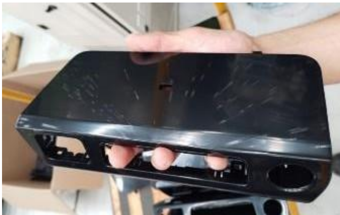
Figura 4.4. pieza con acabado espejo como ejemplo sacado de scrap (Switch panel bezel, Autoría propia., 2023)
