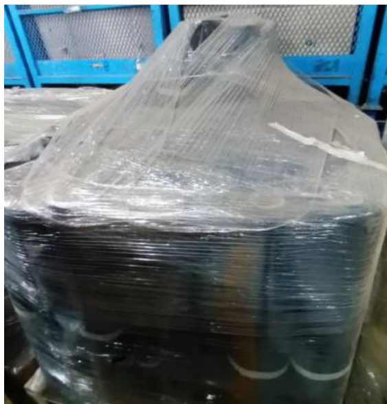
Ilustración 15: mal armado de tarimas
