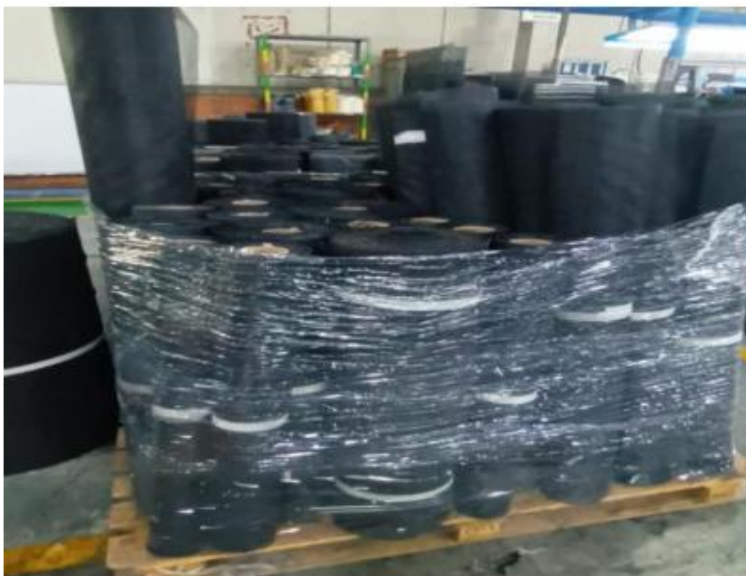
Ilustración 30: carencia en el armado de tarimas
