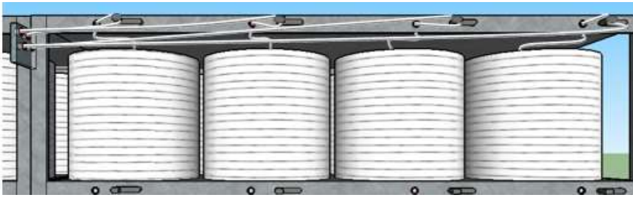
Ilustración 10 colocación de hilos en creels.
