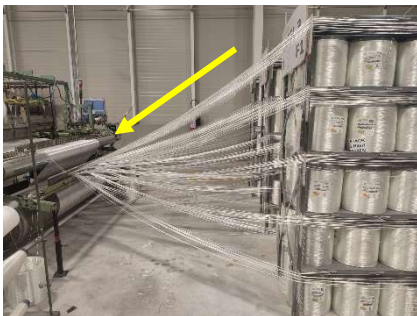
Ilustración 11 hilos en peine delantero
