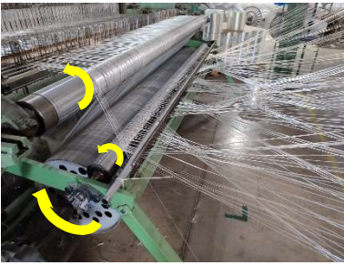
Ilustración 13 Hilo en rodillos.
