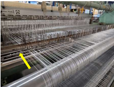
Ilustración 14 repaso de hilos en horquillas.
