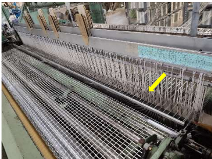
Ilustración 15 repaso de hilos en mallas y calotas.
