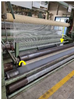
Ilustración 17 enrollamiento de malla.
