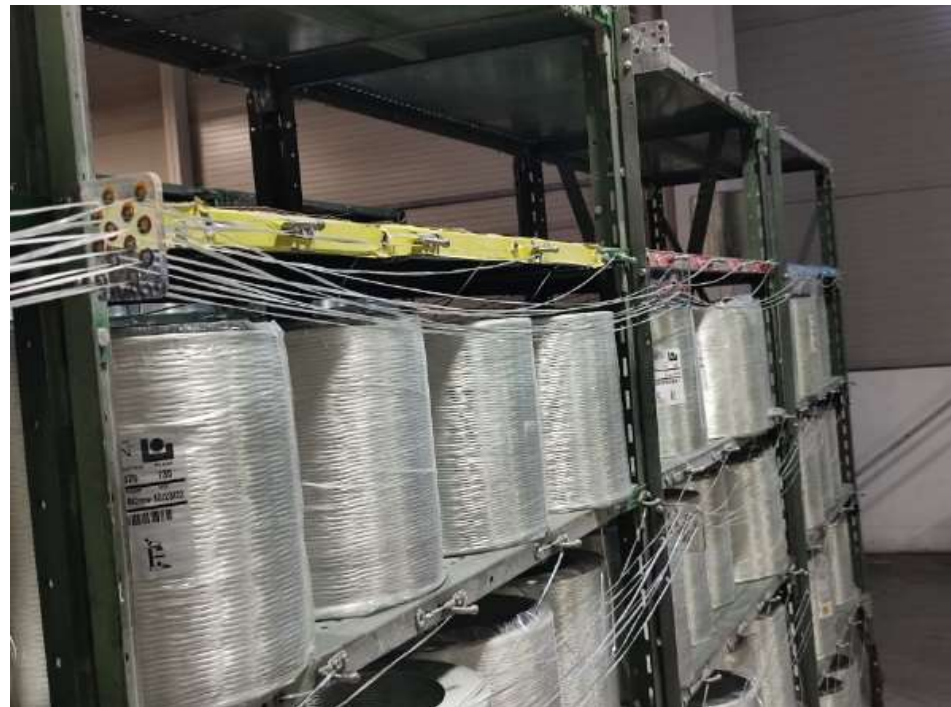
Ilustración 47 Colocación de pantallas con ojillos estandarizados,
