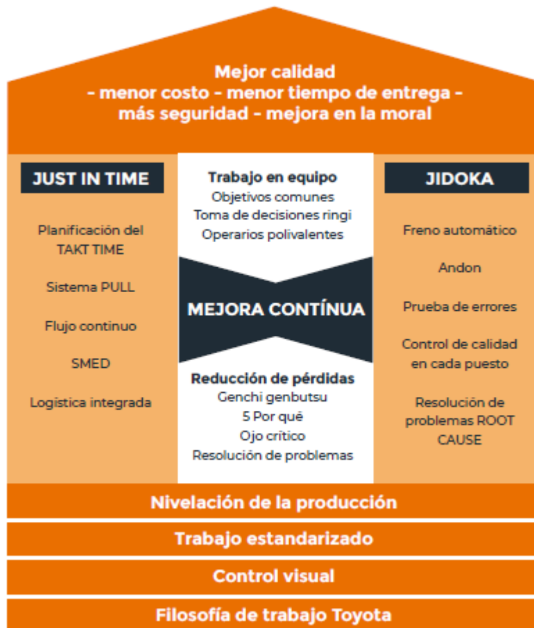
Ilustración 1. Esquema de las herramientas que conforman el Kaizen
