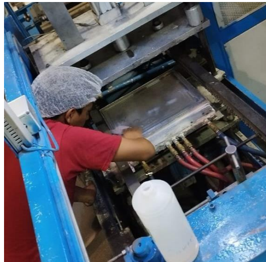
fig. 16 Limpieza de molde
