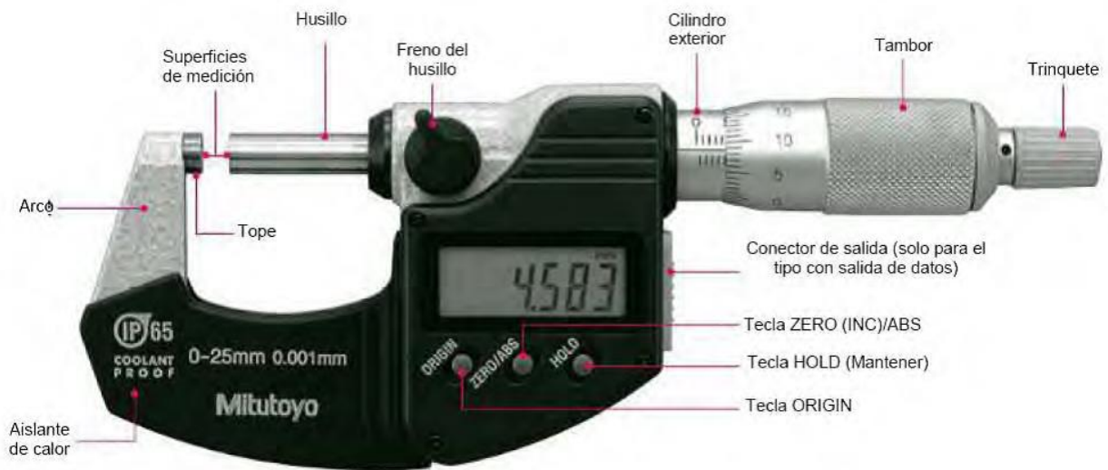
Ilustración 2 Partes de un micrómetro de exteriores digital
