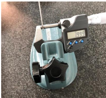
Ilustración 10 Micrómetro de Exteriores en proceso de Calibración
