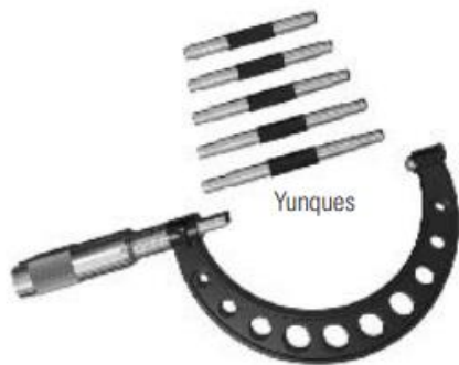
Ilustración 4 Micrómetro de tipo yunque intercambiable.
