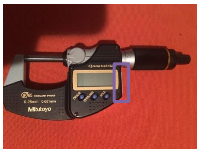
Ilustración 11 Ubicación de entrada de dispositivo para obtención de datos
