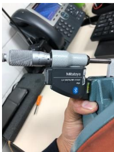
Ilustración 24 Instalación de Transmisor bluetooth a equipo
