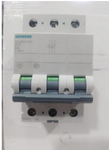
Fig. 4.2.1.1 Interruptor general para el modulo didáctico, montado en riel DIN, marca SIEMENS, 3 Fases, 220 V, 60 Hz, 4 Amp
