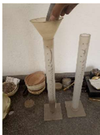
Ilustración 40: Vaciado de material para prueba de equivalente de arena
