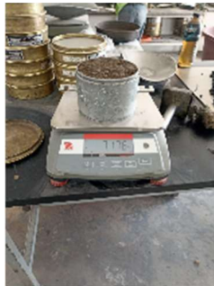
Ilustración 32: Determinación de masa tras compactación en prueba AASHTO (modificado)
