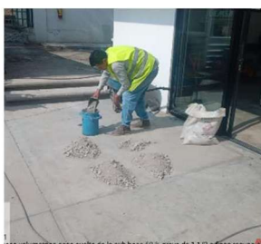
Ilustración 13: Llenado de recipiente para determinación de masa volumétrica
