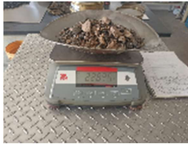
Ilustración 35: Determinación de masas seca de grava para densidad
