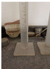
Ilustración 35: Cilindro con solución para equivalente de arena
