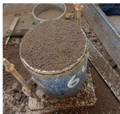
Ilustración 23: Muestra de CBR correctamente enrasada
