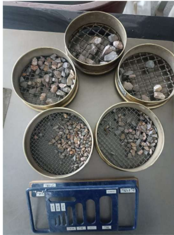
Ilustración 3C: Muestra preparada y cribada para determinar forma de la partícula
