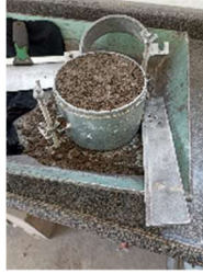
Ilustración 31: Material enrasado en molde AASHTO (modificado)
