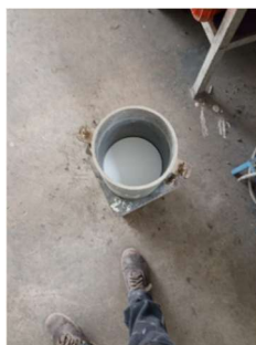
Ilustración 21: Molde para CBR preparado para empezar compactaciones
