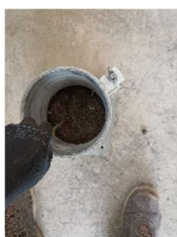
Ilustración 30: Escarificado de capas en prueba AASHTO (modificada)
