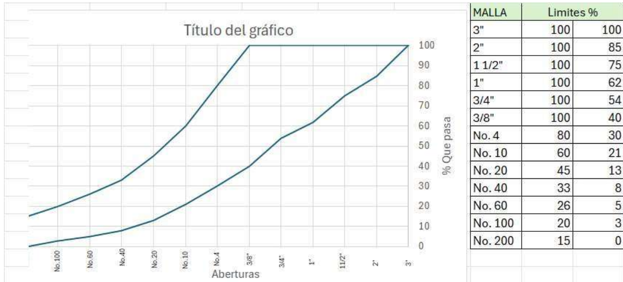
Grafica 12: Limites granulométricos para Sub-Bases según N-CMT-4-02-001
