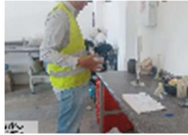
Ilustración 41: Agitado manual de muestra para determinar equivalente de arena
