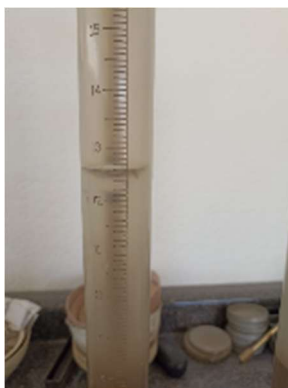
Ilustración 43: Lectura de pisón en prueba de equivalente de arena
