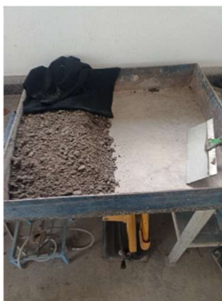
Ilustración 20: Muestra de CBR para terracerías preparada
