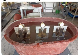
Ilustración 24: Moldes en saturación para determinar expansión
