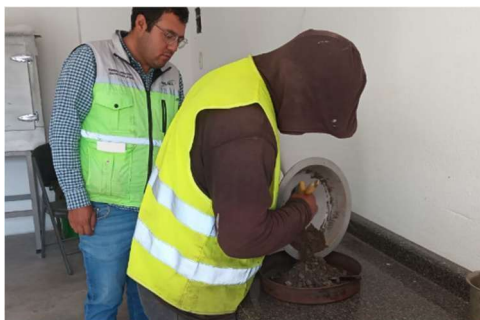
Ilustración 47: Vaciado de material producto de centrifugado a charola para secado
