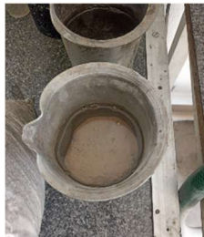
Ilustración 27: Muestra de arenas (finos) saturada para lavado
