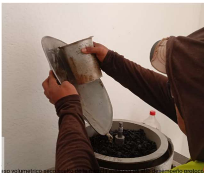
Ilustración 45: Vaciado de muestra en tazón para centrifugado de asfalto
