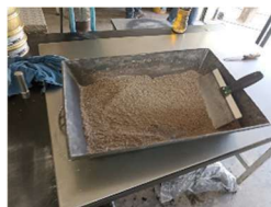
Ilustración 37: Muestra cribada para determinar contenido de arena
