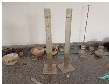
Ilustración 42: Probetas de equivalente de arena ya reposadas
