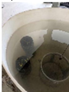
Ilustración 52: Muestra para GMB sumergida para saturarse
