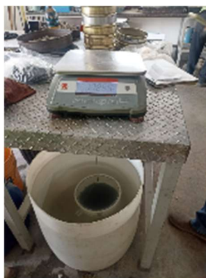
Ilustración 50: Muestra sumergida para determinación de GMM
