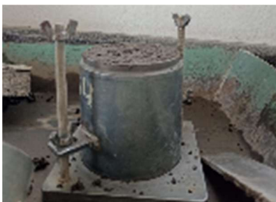
Ilustración 15: Material enrasado en molde AASHTO (estándar)
