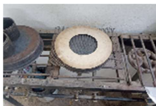
Ilustración 44: Secado de filtro para Rotarex
