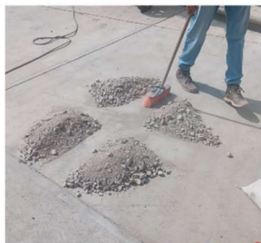
Ilustración 12: Cuarteo de material para determinar masa volumétrica
