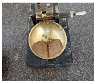
Ilustración 5: Muestra ranurada y cerrada tras ser golpeada en la copa de Casagrande
