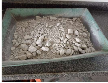
Ilustración 25: Muestra de base lista para granulometría
