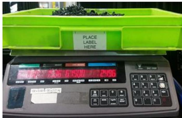
Figura 12 - Conteo de tornillos utilizando báscula
