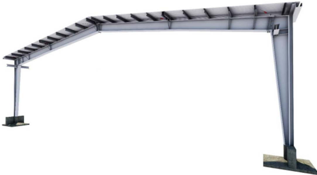
Ilustración 1, 3D de pórtico tipo, claro sin columnas intermedias.
