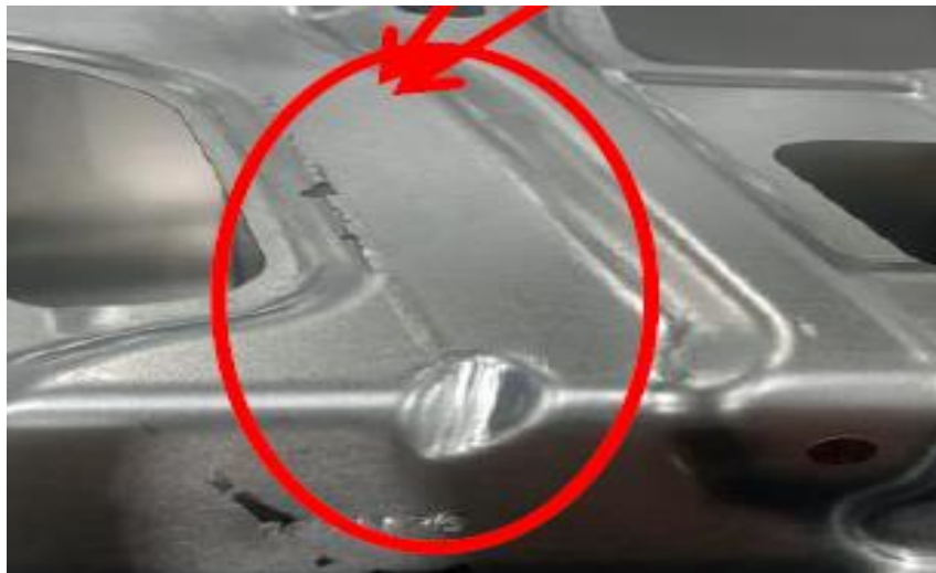
Imagen 3.12 Defectos de Lamina (Desprendimiento de galvanil)
