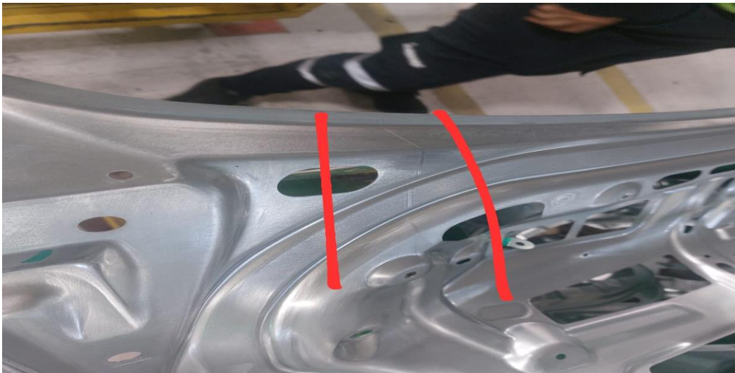
Imagen 3.15 Defectos de Lamina (Marcas de troquel)
