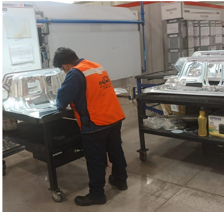
Imagen 3.9 Inspección de Decklid Inner
