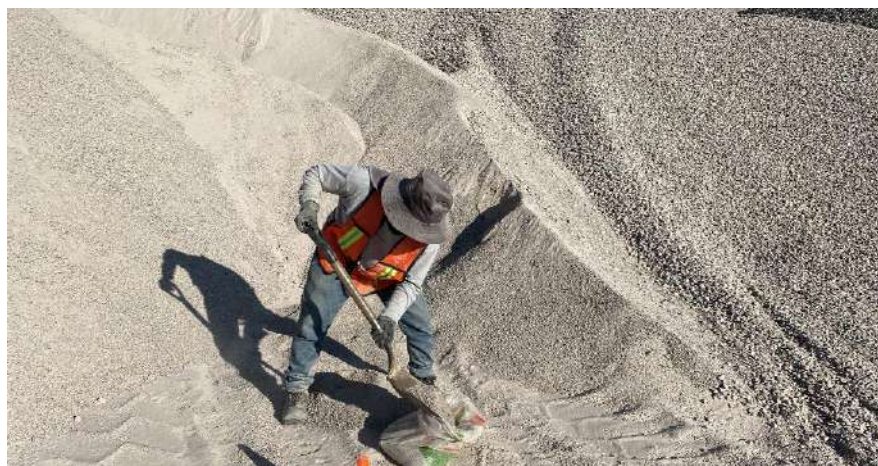
Figura 4.49 Obtención de muestra de arena No. 6. Fuente propia.
