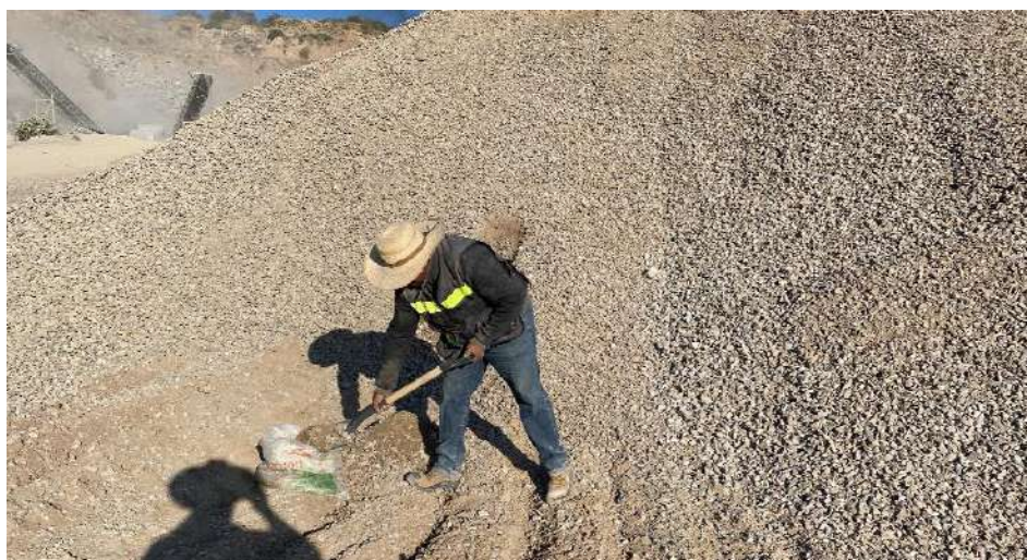
Figura 4.51 Obtención de muestra de base hidráulica No. 4. Fuente propia.
