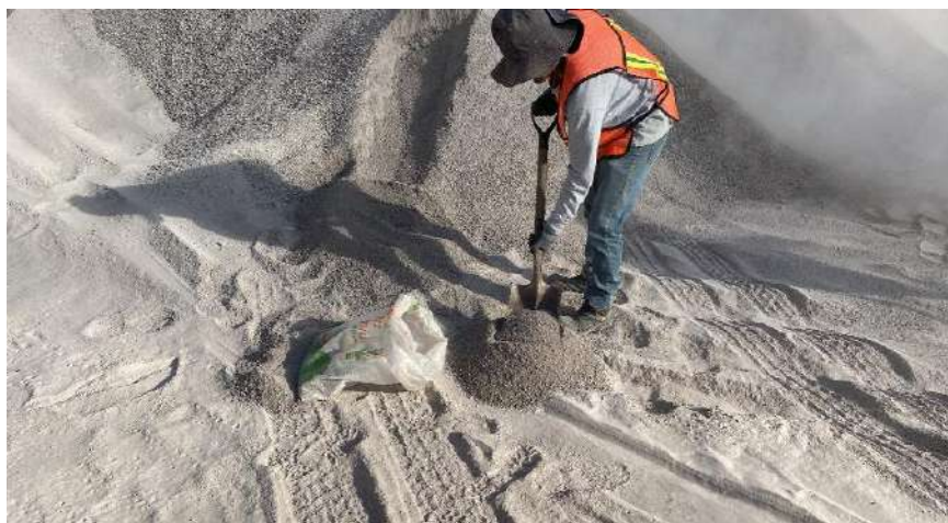
Figura 4.48 Obtención de muestra de arena No. 2. Fuente propia.
