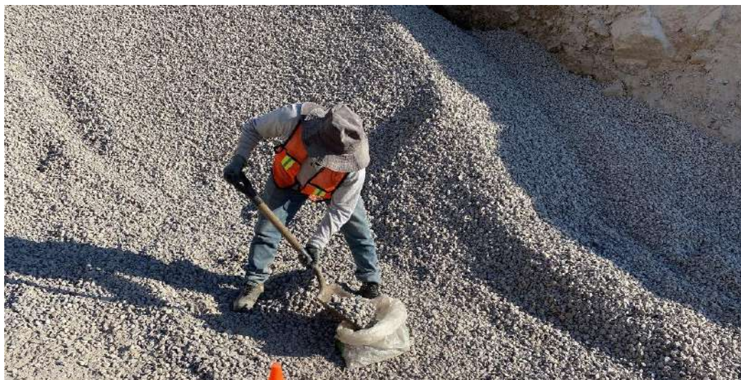
Figura 4.52 Obtención de muestra de grava No. 3. Fuente propia.
