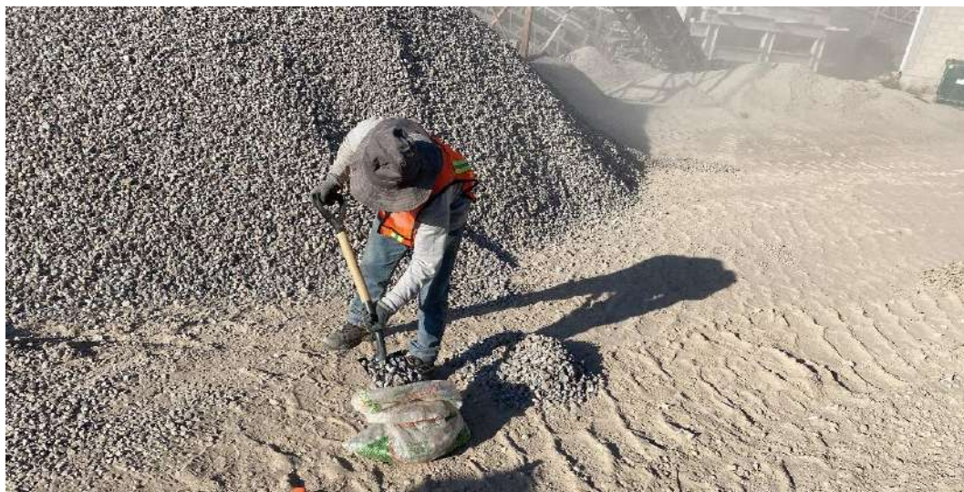
Figura 4.53 Obtención de muestra de grava No. 5. Fuente propia.
