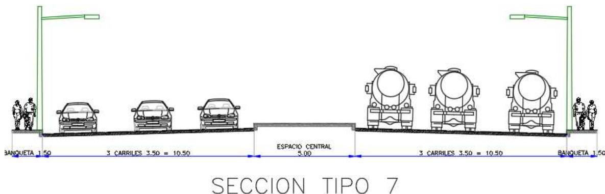
Figura 4.13 Sección tipo 7 cadenamiento 30+180.00. Fuente Secretaría de Infraestructura.
