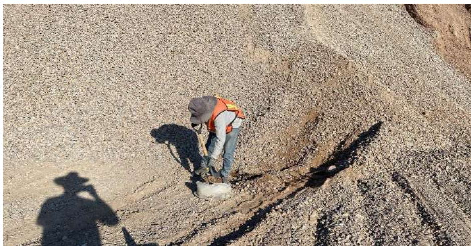
Figura 4.50 Obtención de muestra de base hidráulica No. 1. Fuente propia.
