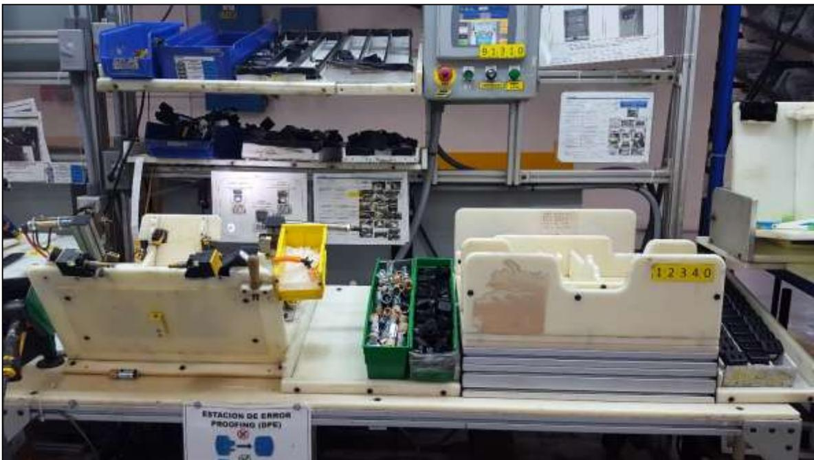
*Ilustración 10.- Estación con falta de identificación de componentes en sublínea Up level en el área K2XX SUV.*
