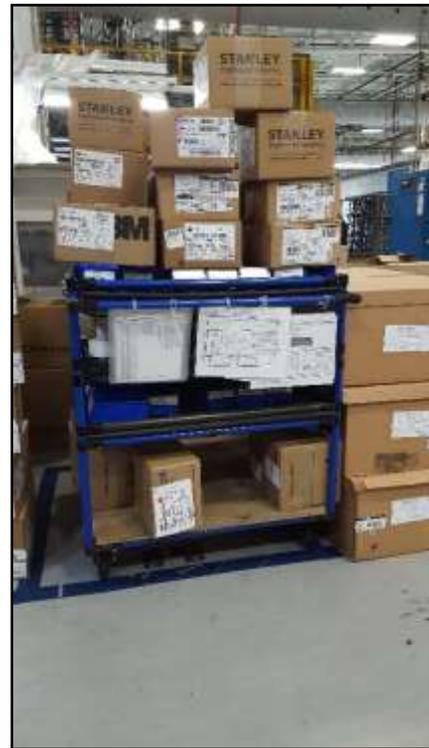
*Ilustración 32.- Exceso de carga en carro de materiales.*
