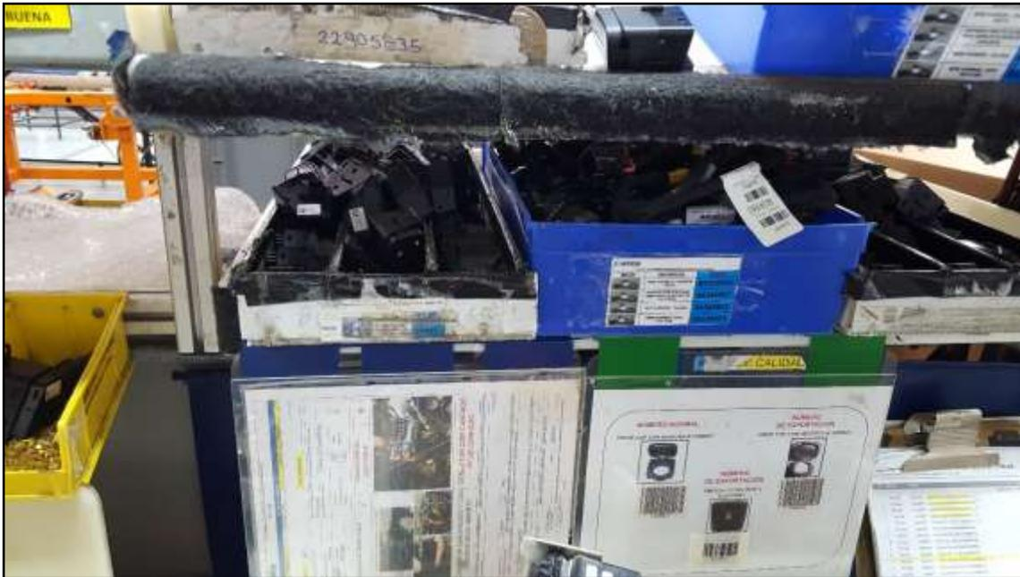
*Ilustración 11.- Componentes en contenedor mal acomodados.*
