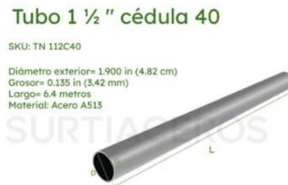
Figura 1 Tubería de Acero al Carbón de 1 ½" Cédula 40
