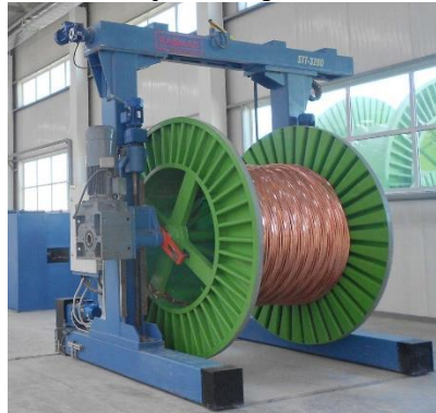
Maquinaria Imagen 15 Embobinador
