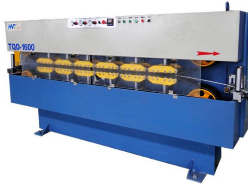
Maquinaria Imagen 4 Caterpuller de entrada
