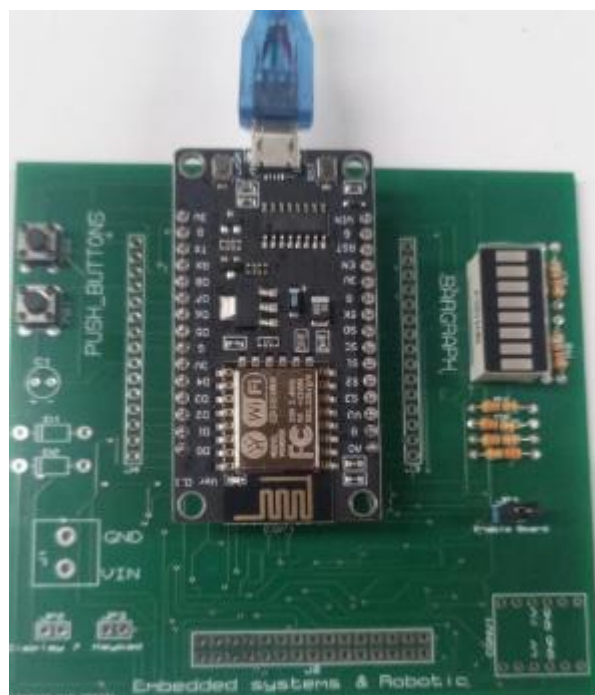
Figura 31. PCB de la tarjeta entrenadora perforada
