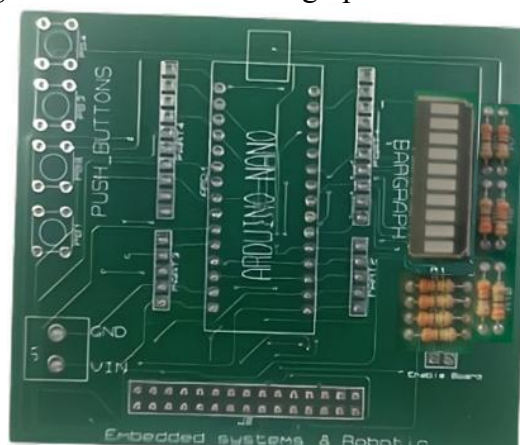
Figura 34. PCB con el bargraph soldado
