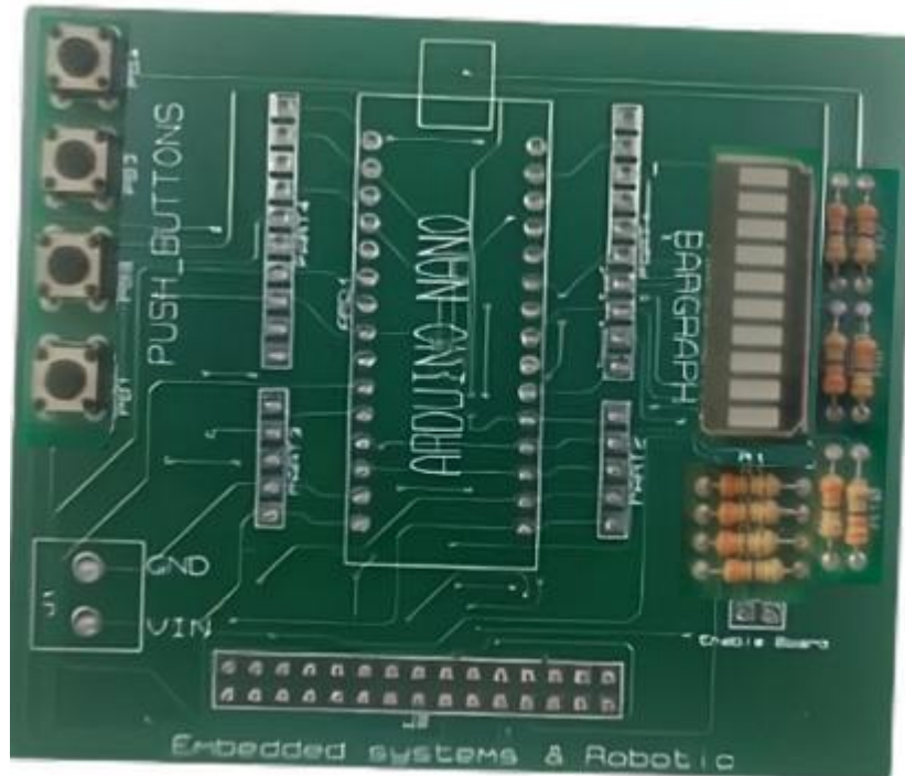
Figura 35. PCB con los botones pulsadores soldados
