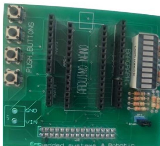
Figura 36. PCB con cabezales hembra y macho soldados
