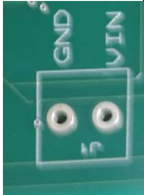
Figura 21. Orificios de las pistas
