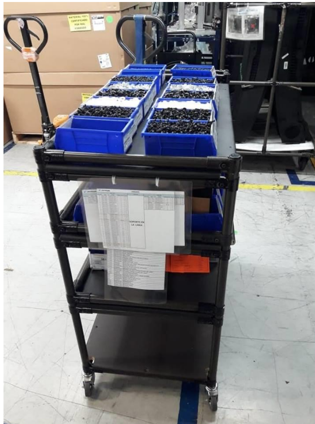
Ilustración 15. Carrito surtidor con bins y horario de relleno en línea.
