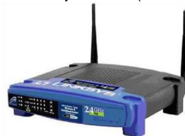
Figura 6 Linksys WRT54G, GS, GL
