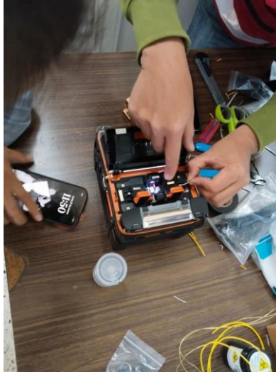
Figura 24 Fusionadora de núcleo de fibra óptica.
