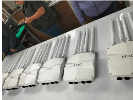
Figura 14 Equipos H3C WA6620X destinados a la red inalámbrica del ITA
