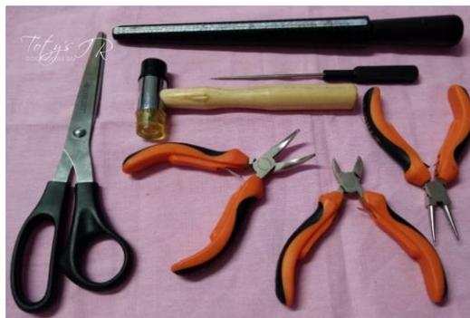
*Ilustración 2 Herramientas para armado.
