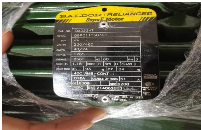
Imagen 3.8 Placa de datos de extractor para acondicionamiento de hornos eléctricos
