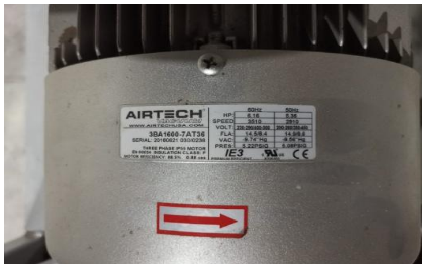
Imagen 3.7 Placa de datos de componente para horno eléctricos (Turbina)
