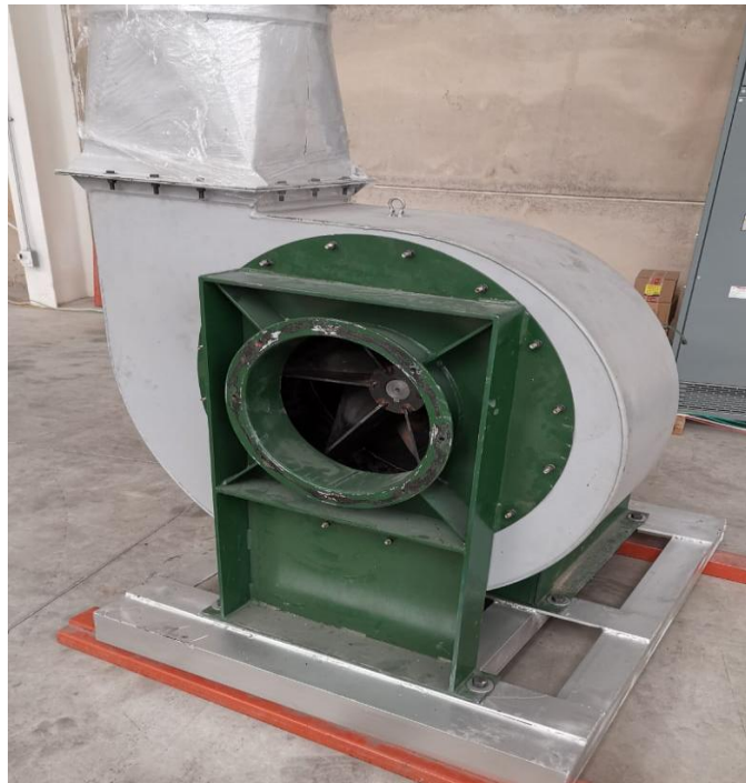
Imagen 3.86 Extractores para acondicionamiento de hornos eléctricos
