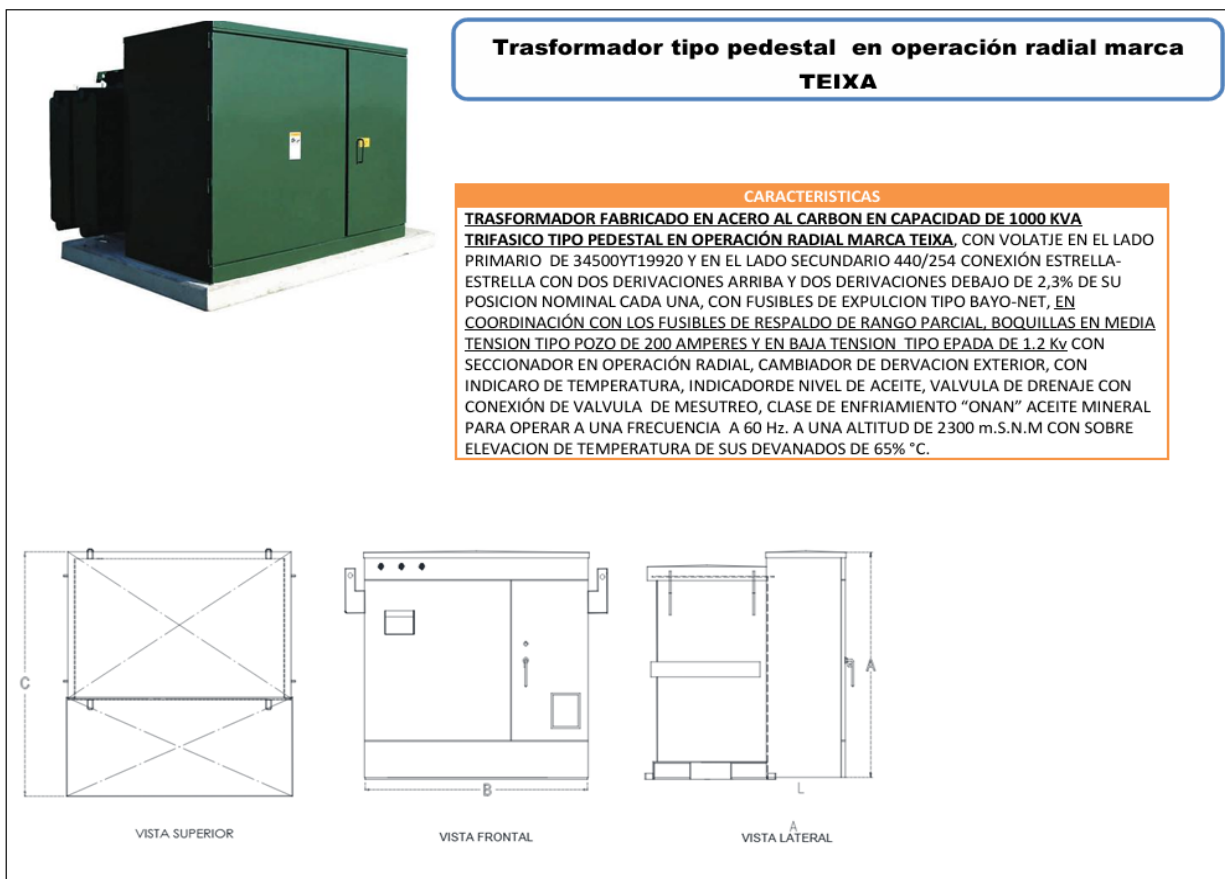
Imagen 3.59 Especificaciones y tabla de datos del transformador a trabajar.
