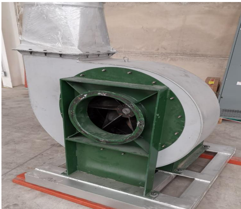
Imagen 3.11 Extractor para acondicionamiento de hornos eléctricos
