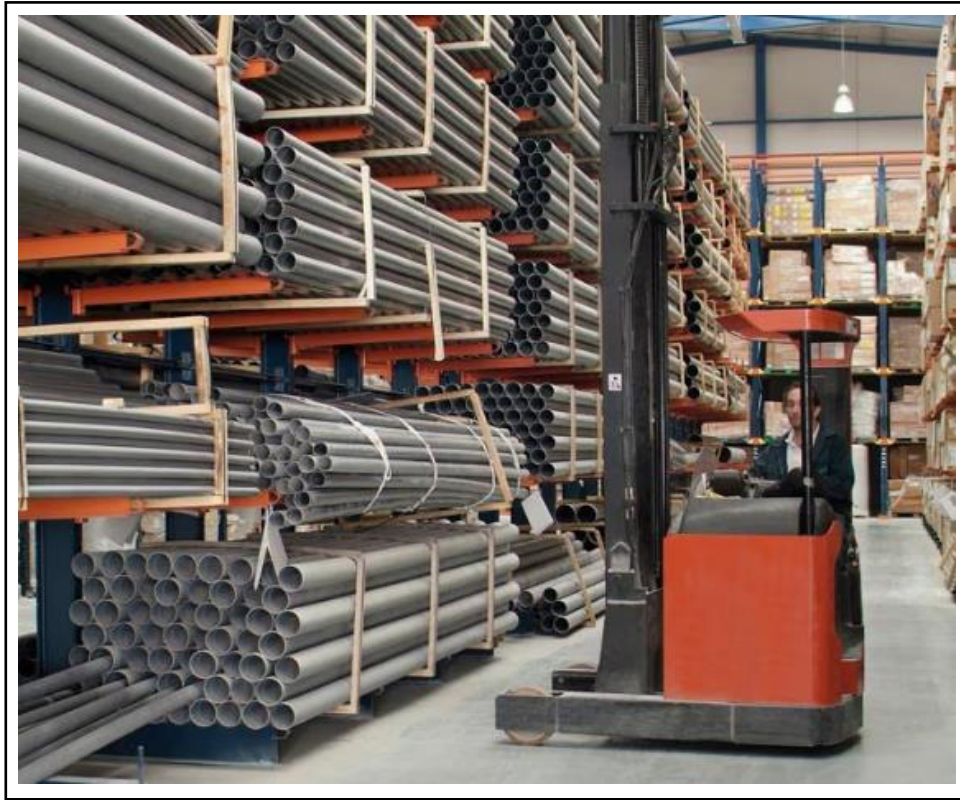
Ilustración 29 Almacenaje de perfiles.
