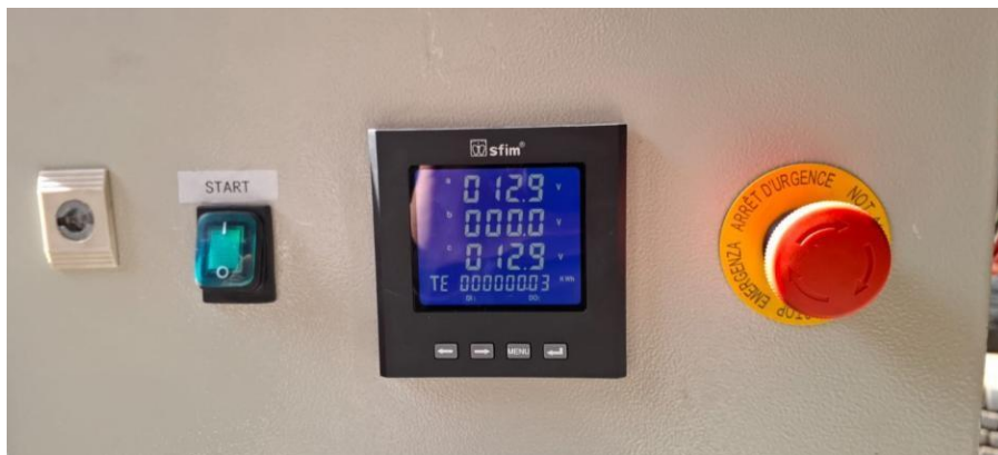
Ilustración 65. Prueba al vacío de la batería conectada al alternador
