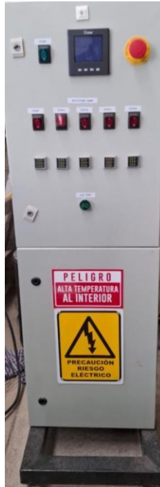
Ilustración 58. Parte frontal del banco resistivo
