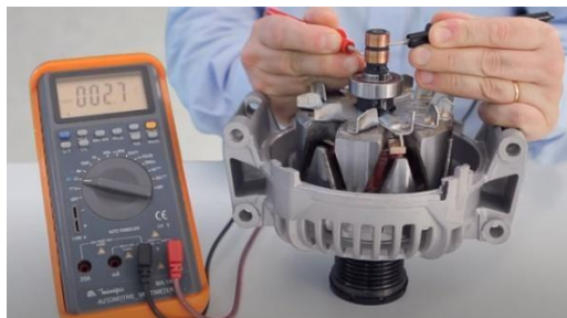
Ilustración 20. Medición de la resistencia del embobinado
