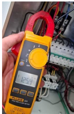
Ilustración 62. Alimentación de 127v al banco resistivo
