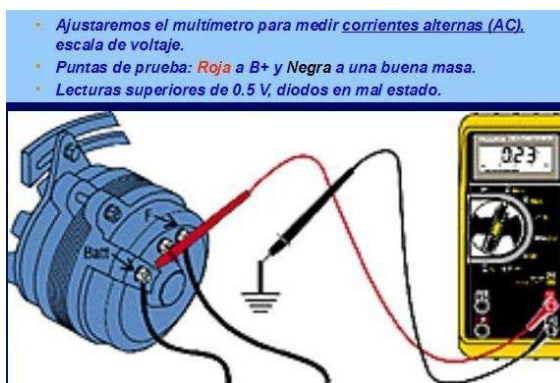
Ilustración 24. Tensión del rizado.
