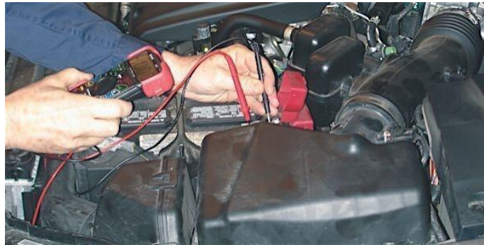
Ilustración 22. Voltaje bajo en la batería.
