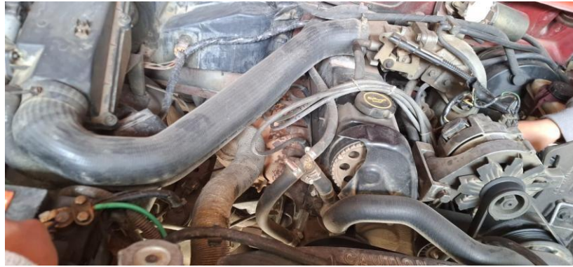
Ilustración 66. Conexión de terminales del alternador con banco resistivo y chasis.
