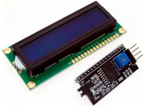
Ilustración 29 Pantalla LCD 16x2 (Mercado Libre).
