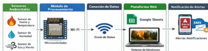
Ilustración 43 Arquitectura del sistema con sistemas embebidos (elaboración propia)
