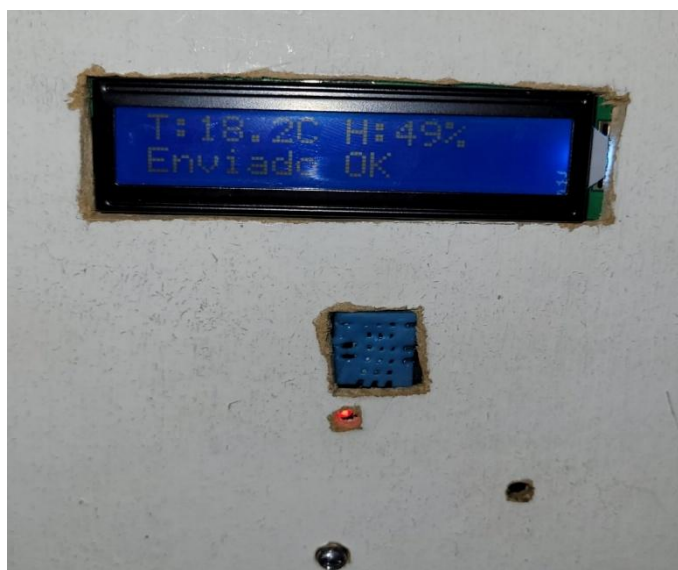
Ilustración 33 Captura de datos del sensor Dht11 mostrados en un LCD (Elaboración propia)
