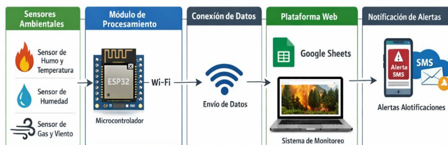
Ilustración 9 Arquitectura del sistema con sistemas embebidos (elaboración propia)
