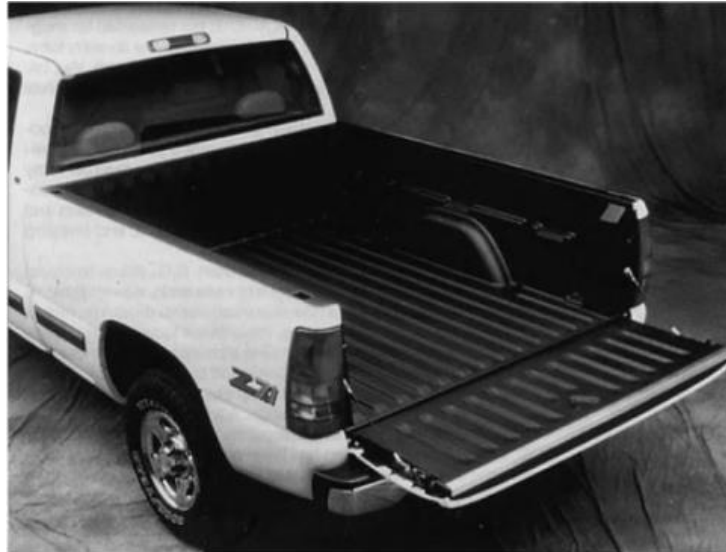
Figura 12. Una caja de carga de una pieza para una camioneta fabricada por el proceso SRIM [66].
