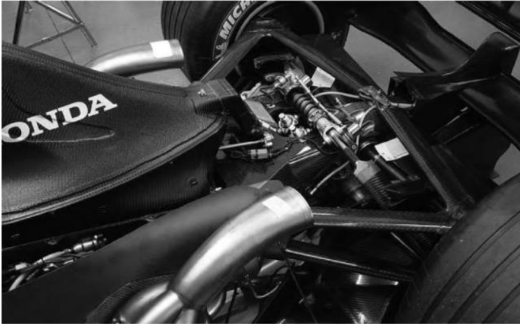
Figura 13. Suspensión y caja de cambios en un auto de carreras de Fórmula 1, fabricadas con RERFC [66].
