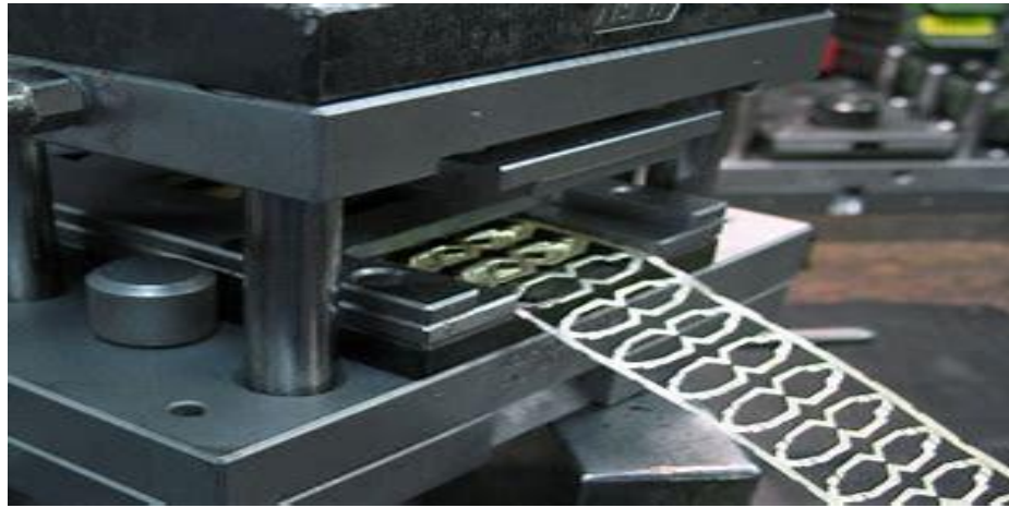
Troquel colocado en una prensa en operación.
