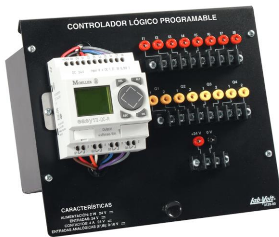
Figura 9.2 Modulo Controlador lógico programable (PLC). 8
