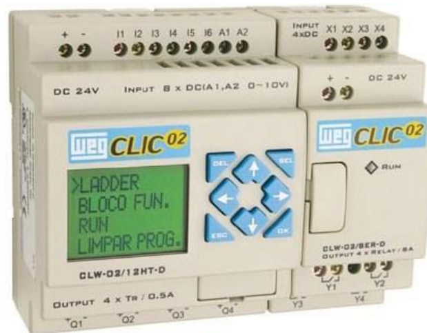
Figura 7.1 Relevador programable temporizador con módulo de expansión. 3
