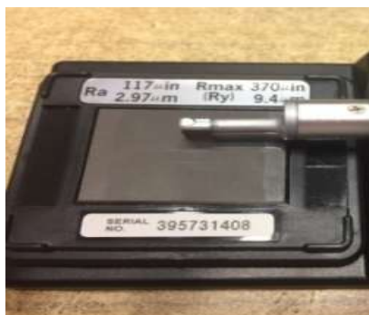
Figura 3.4 Verificación de la calibración del rugosímetro.
