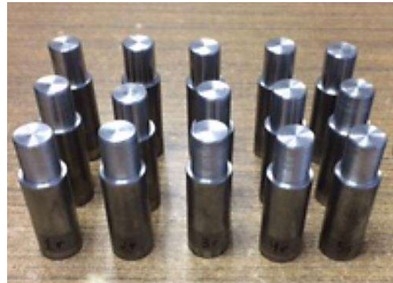
Figura 3.3 Ejes maquinados con diferentes acabados superficiales (fino, medio y rugoso).
