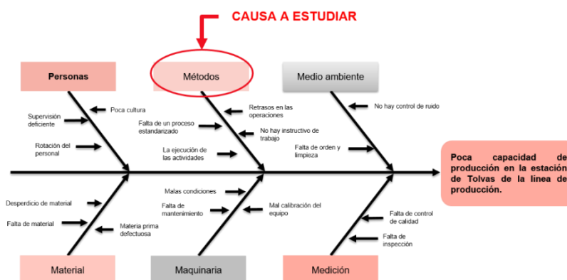
Ilustración 4: Diagrama de Causa y Efecto de la problemática en la línea de TCO Group.
